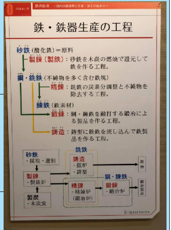
砂鉄による鉄製造工程
